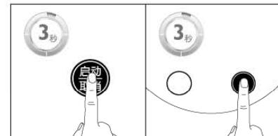
3 豆浆机发出三声“嘀、嘀、嘀”时伴随着指示灯闪烁三次，即完成自适应功能（注意：如果没有以上现象，请拔下电源，重复以上操作）
