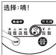
按“选择”键选择相应的功能程序，对应功能指示灯（或图形指示灯）亮并闪烁，按“启动/取消”键启动制作程序，机器伴有“滴滴”两声提示音，提示程序已启动。
